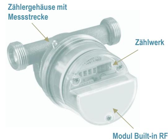
Die **integrierten Funkübertragungsmodule** (Built-in RF) der **EcoMatrix-Plattform** sind zur Montage auf Gehäusen von SingleJet-Kalt-/Warmwasserzählern verschiedener Hersteller vorgesehen. Das RF-Modul misst und überträgt in Echtzeit per Funkkanal Verbrauchsdaten und Alarme bei magnetischer Manipulation.
