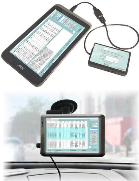
Das **WalkBy-Ablesesystem** ist eine Methode zur Datenerfassung von verschiedenen Messgeräten. Dabei bewegt sich der Benutzer zu Fuß oder im Fahrzeug entlang einer definierten Route und empfängt die Informationen auf einem **Tablet oder Notebook**, das mit dem **RF-Terminal EM3011** und einer speziellen Software verbunden ist.
