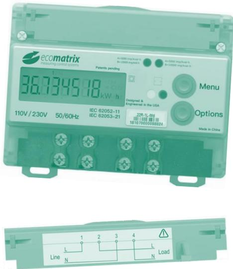
**Statische Einphasen-/Dreiphasen-Stromzähler mit integrierten Funkmodulen der EcoMatrix-Plattform** sind für den Betrieb in zweipoligen Wechselstromnetzen mit einer Nennspannung von 110/230 V und einer Frequenz von 50/60 Hz ausgelegt und ermöglichen die **Echtzeitübertragung per Funk von Verbrauchsdaten und Alarmen** (magnetische Manipulation, Vandalismus).
