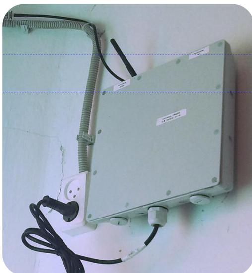
Der **GateWay RF EM4018 Datenkonzentrator** ist für den **Empfang von Daten über Funk** von Funkmodulen und Repeatern der EcoMatrix-Plattform ausgelegt. Die Daten werden in einem **nichtflüchtigen Speicher** abgelegt und über verschiedene Kommunikationskanäle wie **GPRS/3G/LTE** und **Ethernet** an den **Server des Zentrums für Datenerfassung und -verarbeitung** weitergeleitet.
