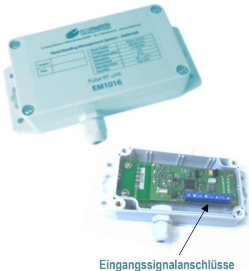
Das **Impuls RF-Modul EM1016** dient zur Erfassung, Speicherung und Übertragung von Verbrauchsdaten (aktuell, stündlich und täglich) über Funk von Wasser-, Strom- und Gaszählern mit Impulsausgängen sowie von Alarmgeräten mit digitalen Ausgängen.
