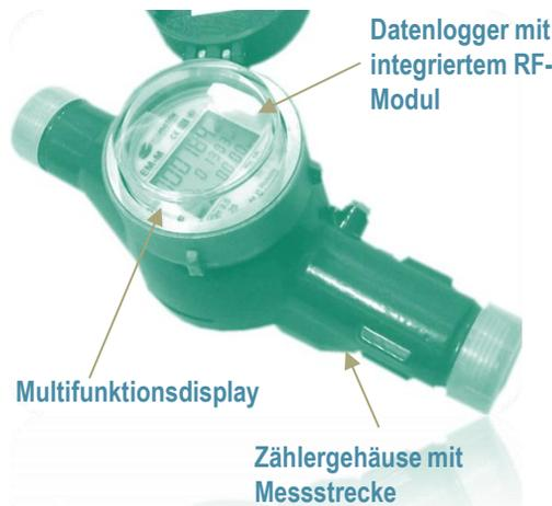
**MultiJet-Wasserzähler EM-M** dienen der Messung, Archivierung und drahtlosen RF-Übertragung des Volumens von Trinkwasser in Kaltwassersystemen (0,1 bis 50 °C, bis zu 16 bar) und Warmwassersystemen (0,1 bis 90 °C, bis zu 16 bar). Nennweiten (DN): **15, 20, 25, 32, 40, 50 mm**.
