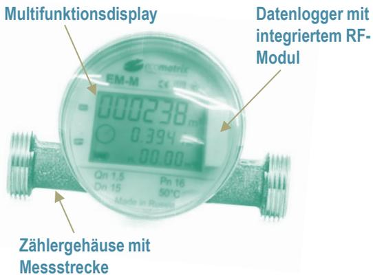
**EM-S SingleJet-Wasserzähler** (DN15/20) für Warm- und Kaltwasser verfügen über autonome Stromversorgung und integrierte RF-Sendemodule der **EcoMatrix-Plattform**. Sie dienen der individuellen Verbrauchserfassung und übertragen in Echtzeit Verbrauchsdaten (sowohl kumuliert als auch aktuell) sowie Alarmsignale (**magnetische Manipulation, Umgebungstemperaturüberwachung, Vandalismus, Rückfluss usw.**).
